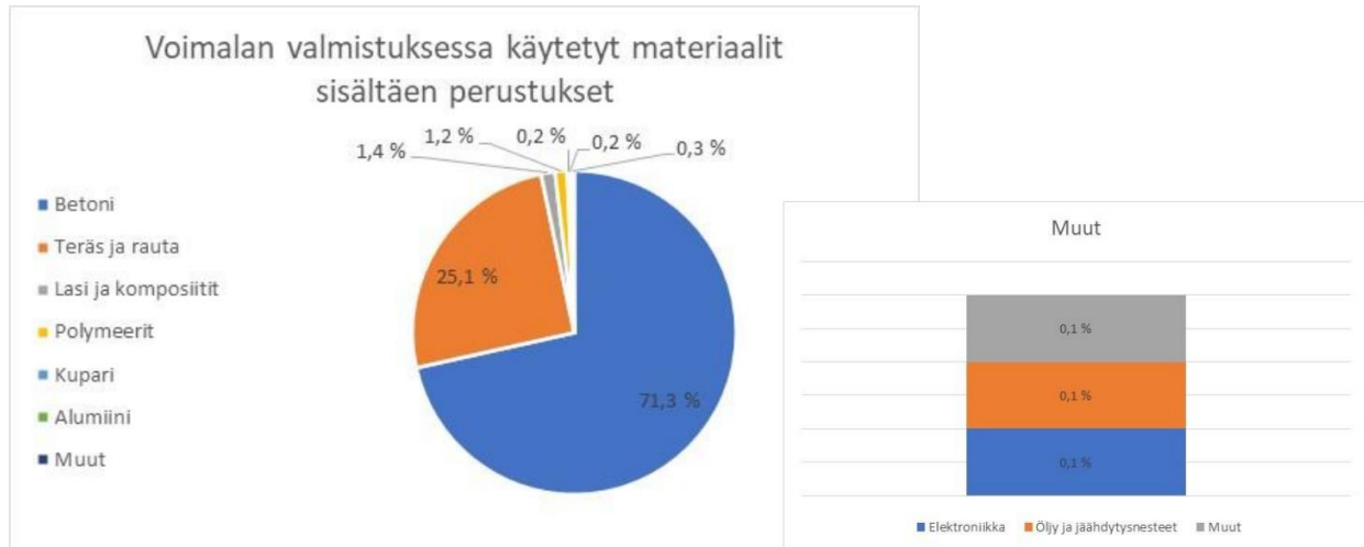
Kuva 172. Esimerkki voimalan valmistuksessa käytettävistä materiaaleista sisältäen voimalaperustukset ja niiden osuus koko voimalan massasta Voimalamalli Vestas V150-4,2 MW. (Vestas 2022b)
