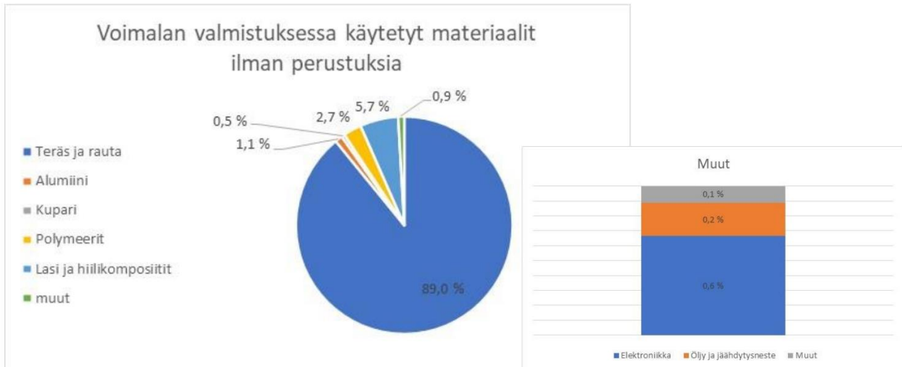
Kuva 125. Esimerkki voimalan valmistuksessa käytettävistä materiaaleista pois lukien voimalaperustukset ja niiden osuus koko voimalan massasta Voimalamalli Vestas V150-4,2 MW. (Vestas 2022b)
