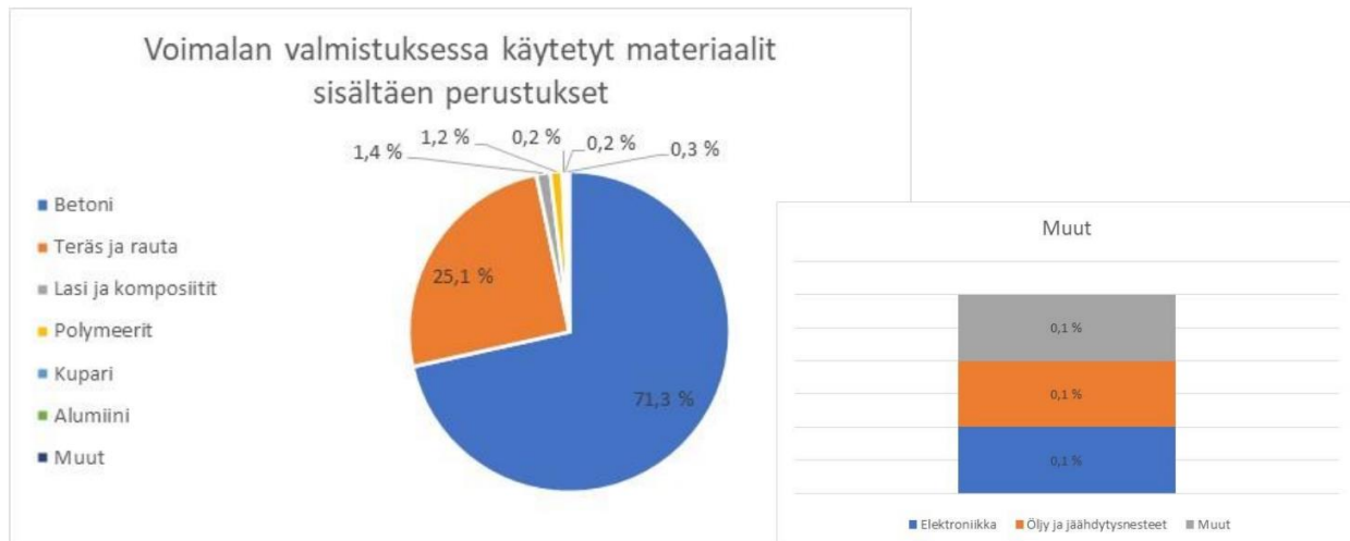
Kuva 126. Esimerkki voimalan valmistuksessa käytettävistä materiaaleista sisältäen voimalaperustukset ja niiden osuus koko voimalan massasta Voimalamalli Vestas V150-4,2 MW. (Vestas 2022b)
