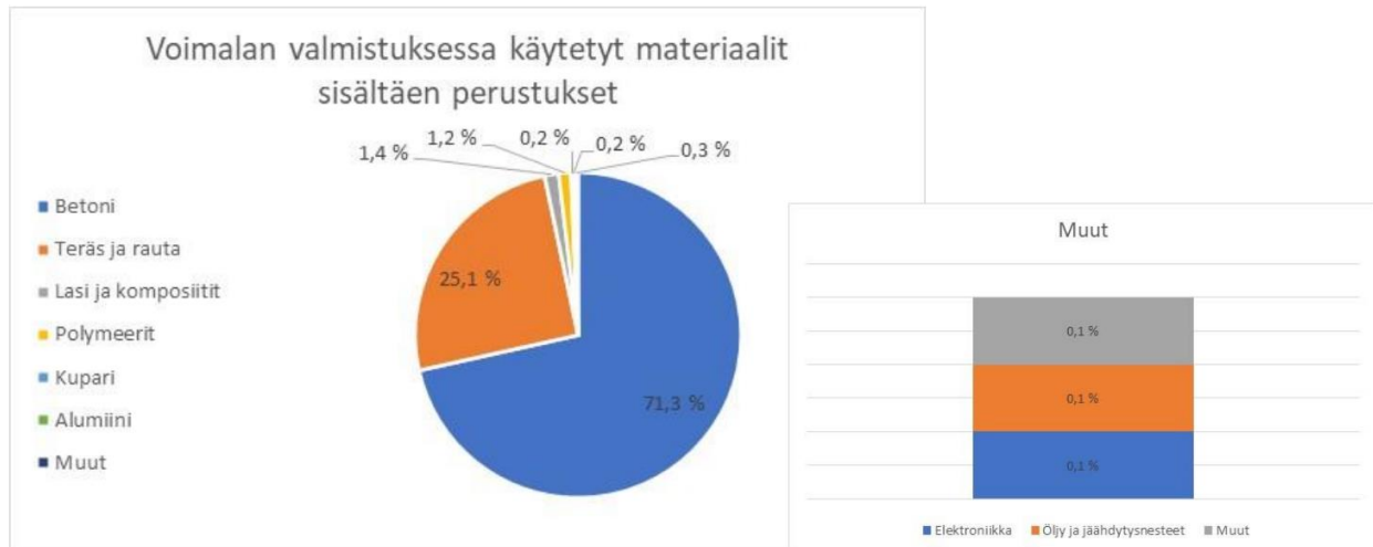
Kuva 129. Esimerkki voimalan valmistuksessa käytettävistä materiaaleista sisältäen voimalaperustukset ja niiden osuus koko voimalan massasta Voimalamalli Vestas V150-4,2 MW. (Vestas 2022b)
