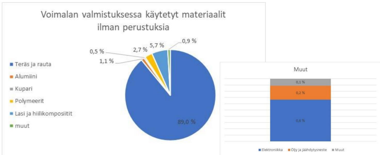
Kuva 128. Esimerkki voimalan valmistuksessa käytettävistä materiaaleista pois lukien voimalaperustukset ja niiden osuus koko voimalan massasta Voimalamalli Vestas V150-4,2 MW. (Vestas 2022b)
