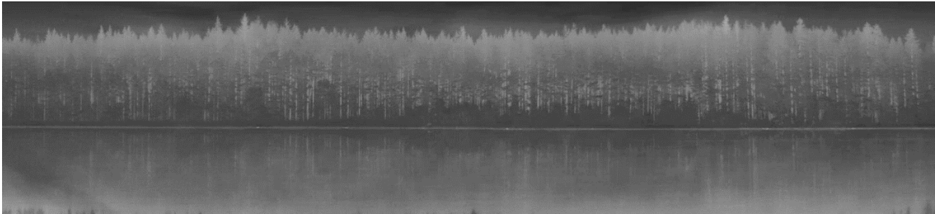
Kuva 2. Lämpötähystimellä voidaan tarkastaa nopeasti laajoja alueita. Kuvassa noin 300 metrin päässä lammen vastarannalla näkyy rantaviivassa ympäristöään lämpimämmät kohteet vaaleina (tässä kiviä tai ruohotuppaita). Laitteen erottelukyky on parhaimmillaan noin 40 mK (= 0,04 °C).
